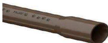
Utiliza adesivo e solução limpadora para fazer a união dos tubos com as conexões, geralmente de cor marrom. Antes de fazer a junção entre as peças é necessário lixar a ponta do tubo e o interior da conexão até desaparecer
