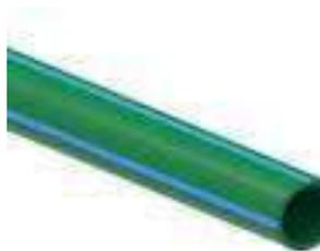
Polipropileno Copolímero Random – são tubos e conexões unidos por termofusão a 260°C, formando uma tubulação única, sem o risco de vazamentos e sem a utilização de colas e fazer roscas. São indicados principalmente para água quente no que dispensa o isolamento térmico, aquele tipo de espuma que envolve as tubulações de cobre. A temperatura de trabalho é considerada na temperatura de 70°C, mas suportam picos de até 95°C.
